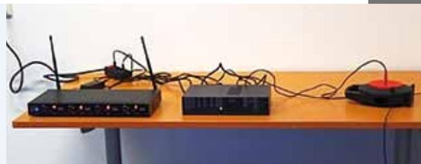
Die neu angeschaffte mobile Ringschleifen-Induktionsanlage.
